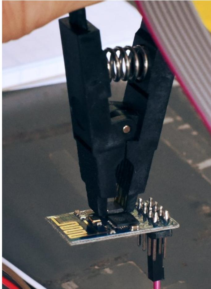
对于ESP8266, CPU 需要保持在重置状态，以便保证在SPIDriver 驱动Flash芯片时不会产生竞争。连接SPIDrive 的A信号（紫色）到ESP8266的重置信号：
