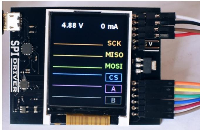
按照下图所示的顺序连接六个颜色的信号线。
